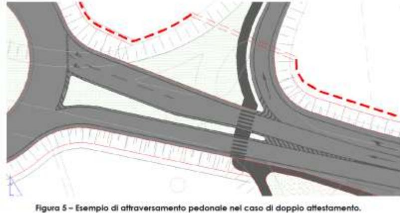
Figura 5 - Esempio di attraversamento pedonale nel caso di doppio attestamento.
